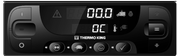
Figure 6 : Panneau de commande HMI standard
